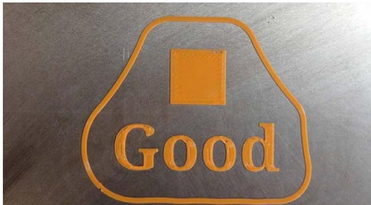
Wenn die Quadrate des Testdrucks zu weit oder zu nah an der Düse erscheinen, nehmen Sie die erforderlichen Anpassungen vor und führen Sie den Testdruck erneut durch.
